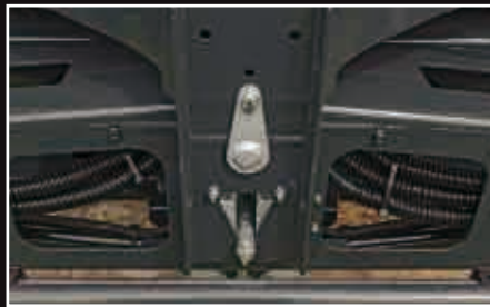
Hydraulische Verriegelung des Pendelsystems
