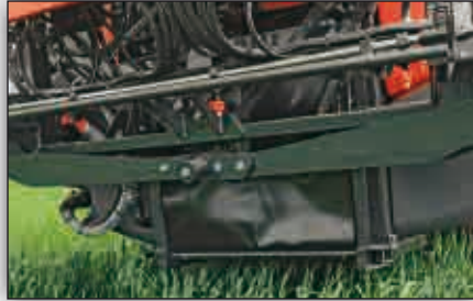
Dämpfungssystem für unabhängige Dämpfung des linken und rechten Gestängeauslegers sowie ruhiges Gestängeverhalten.
