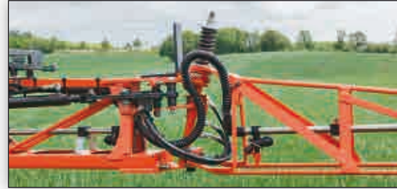
Anfahrssicherung des rechten Gestängeauslegers
